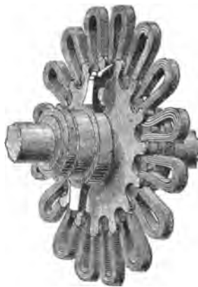
Induit de l'alternateur Ferranti ( fig. 273 ).
